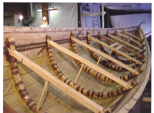
Les membrures et le bordé assemblés par ligatures du Gyptis (Photo : Eric Rieth, CNRS)
